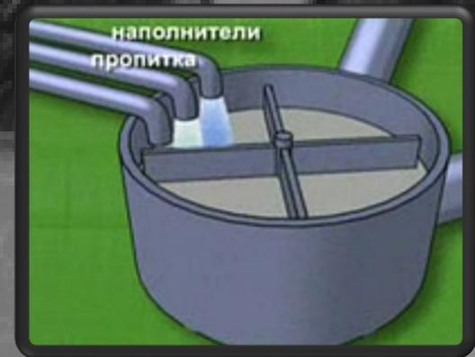
Измельченные щепки варят в специальных машинах, добавляют кислоту, пропитку, различные красители. Получается бумажная масса.
